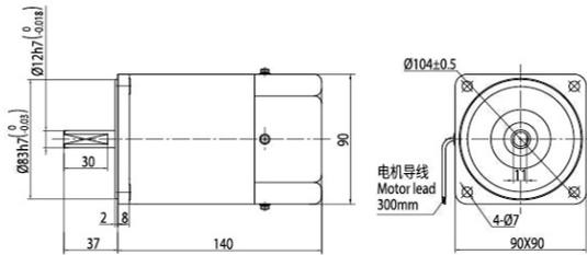
● **组合: 引线型电机 + 标准减速箱 (减速比 1:3~200)**
