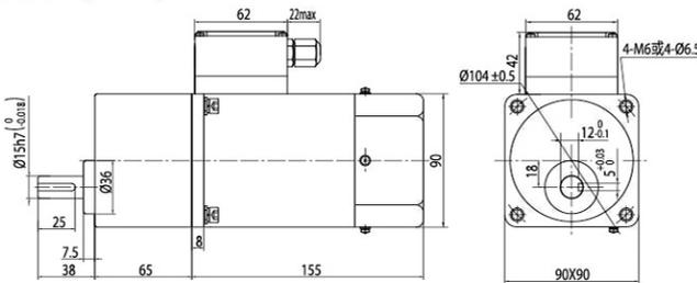
● **组合: 引线型电机 + 带耳型减速箱 (减速比 1:3~200)**
