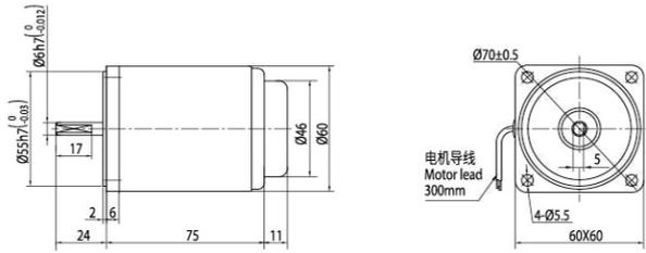
● **组合: 引线型电机 + 标准减速箱 (减速比 1:3~200)**
