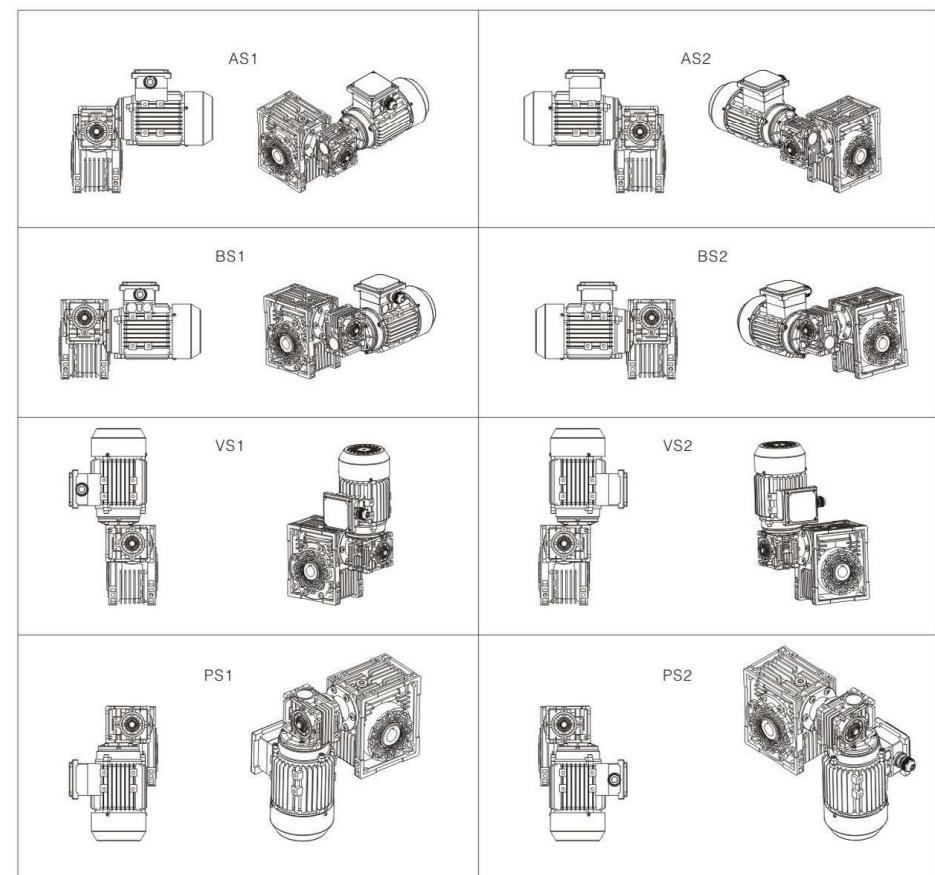
注：第一级和第二级减速器按上图方式组合，如在定货时没有特别说明，将按照BS2组合方式供货；第二级减速器实际安装方式参照23页的安装方位图。
