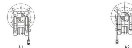
注: 如没有特别说明, 将按照如图A1和B3安装方面的组合样式供货。
