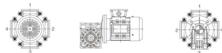
注: 如对电机接线盒位置有特别要求, 订购时须参考上图的要求指定接线盒方位, 否则接线盒方位将按安装方位图表中的方位提供。
