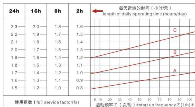
启动频率Z: 周期包括所有启动，制动的次数以及变速电机高低速变化时的次数。
